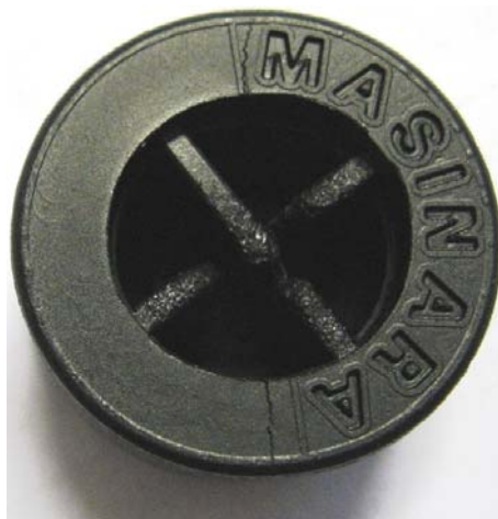
FOTO N° 6 Dopo -30° C: Inizio rottura a 256 daN (=251.14Kg)
