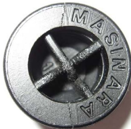
FOTO N° 4 T.A. 25°C: Inizio rottura a 266 daN (=260.95Kg)
