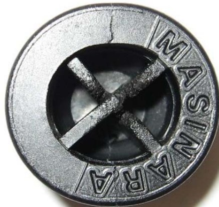
FOTO N° 4 T.A. 25°C: Inizio rottura a 266 daN (=260.95Kg)
