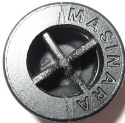
Photo N. 4 T.A. 25°C: Début rupture à 266 daN (=260.95Kg)
