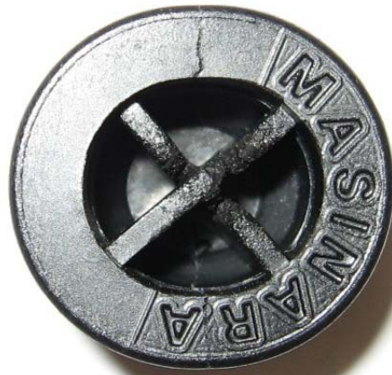
Photo N. 4 T.A. 25°C: Début rupture à 266 daN (=260.95Kg)
