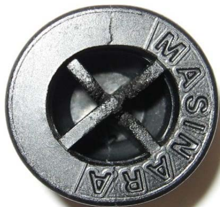
DIBUJO N° 4 T.A. 25°C: Inizio de rotura a 266 daN (=260.95Kg)
