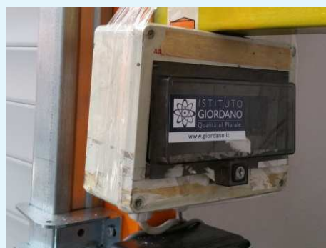
Fotografie della sigillatura dei contatti e fotografia dei contatti al termine della prova.
