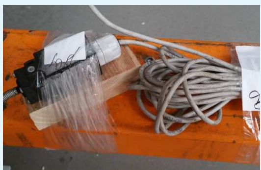
Photographies du scellage du compteur de cycles et photographie du compteur de cycles à la fin de l'essai.
