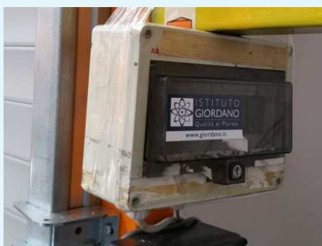
Photographies du scellage du compteur de cycles et photographie du compteur de cycles à la fin de l'essai.
