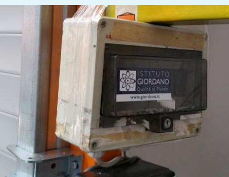
Fotografías del sellado del contador de ciclos y fotografía del contador de ciclos al final del ensayo.
