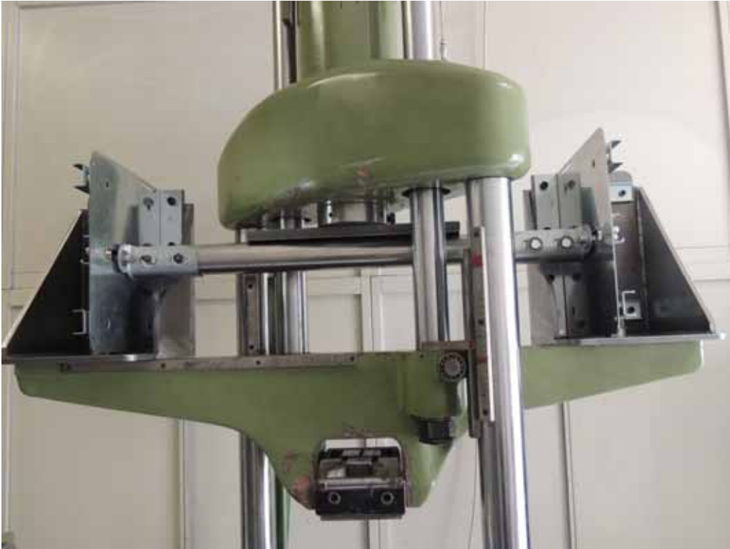
Foto N°10 – Guida esterna – Albero Ø 60 mm pieno – Inizio prova
