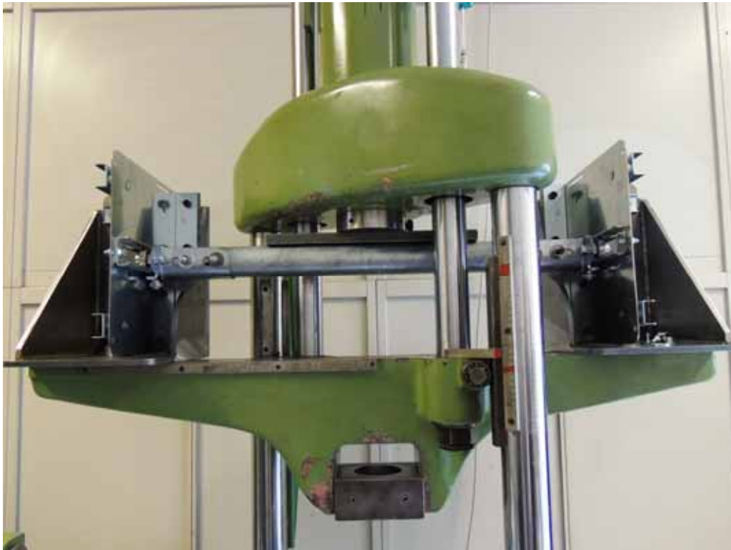
Foto N°6 – Guida interna – Albero Ø 60 mm – Inizio prova
