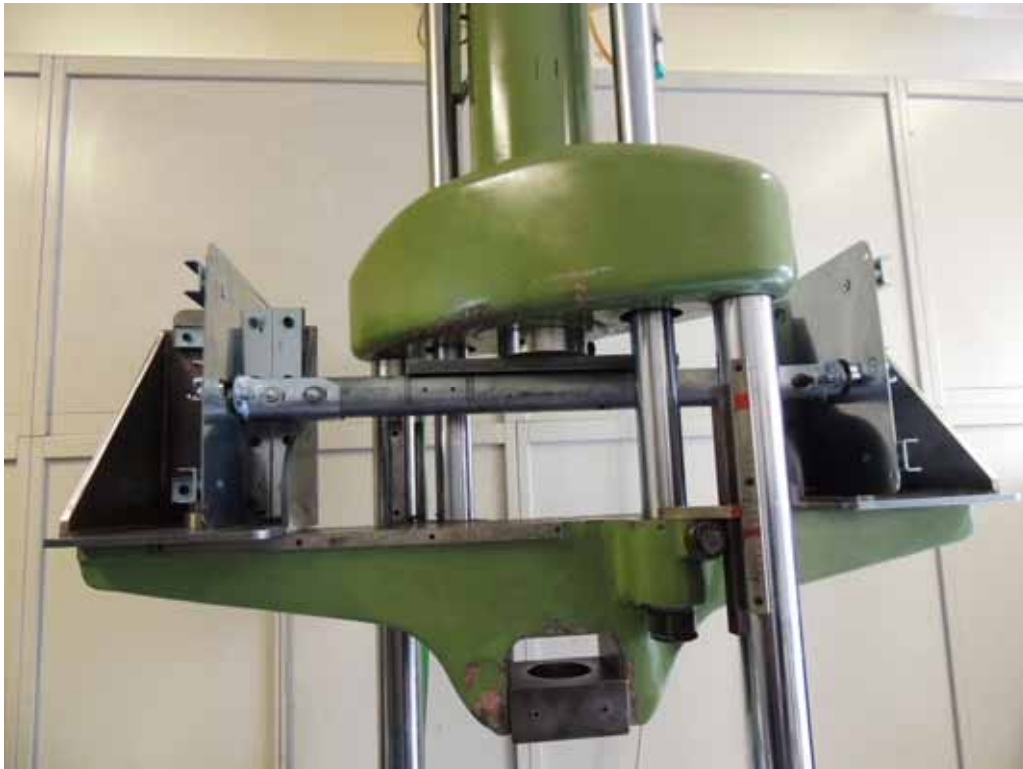
Foto N°1 – Guida esterna – Albero Ø 60 mm – Inizio prova
